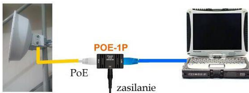
Rys. 11.2. Połączenie punktu dostępowego Ubiquiti, komputera i zasilania
