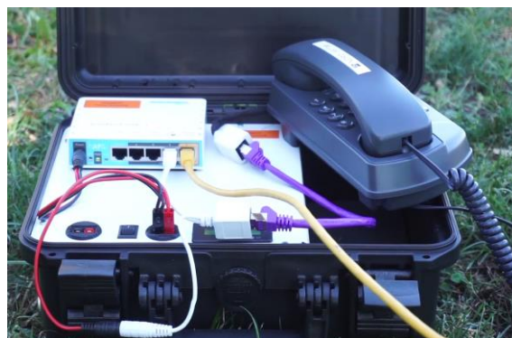
Rys. 11.6. Przenośna stacja walizkowa z akumulatorem 8 Ah, punktem dostępowym WLAN i telefonem VoIP
