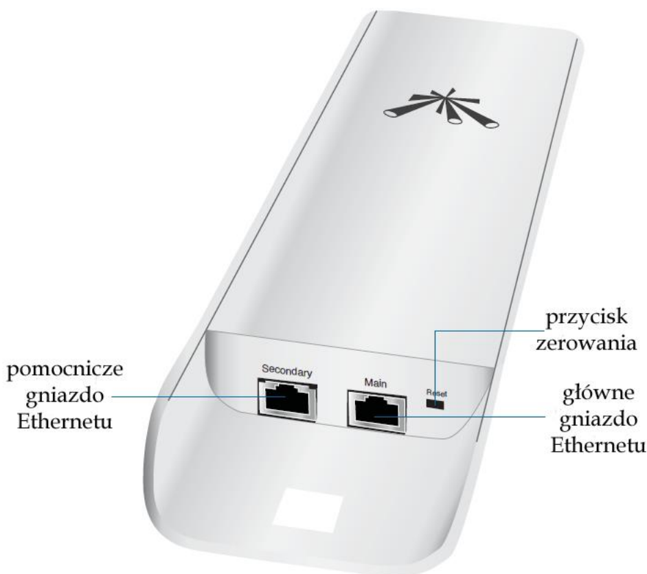
Rys. 3.1.1. Widok „Nanostation”. W drugie gniazdo Ethernetu są wyposażone jedynie modele M2/M3/M5. Do zasilania przez kabel ethernetowy należy użyć zasilacza 24 V. „Nanostation Loco” posiada tylko jedno gniazdo
