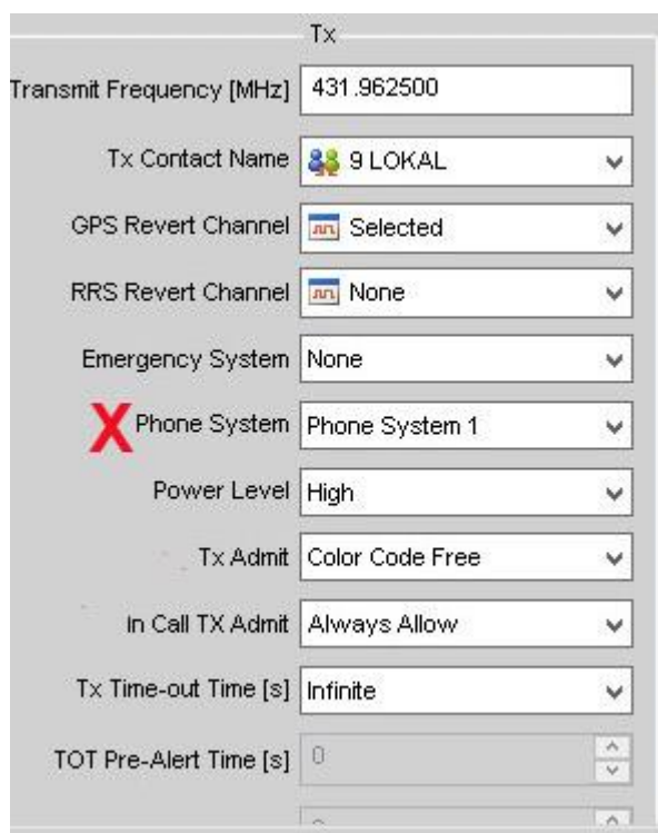
Rys. 7.0.1.1. Do kanału lokalnego DMR (TG9) dla przemiennika bramki DMR-SIP przypisana jest konfiguracja telefoniczna, tutaj pod nazwą „Phone System 1”
