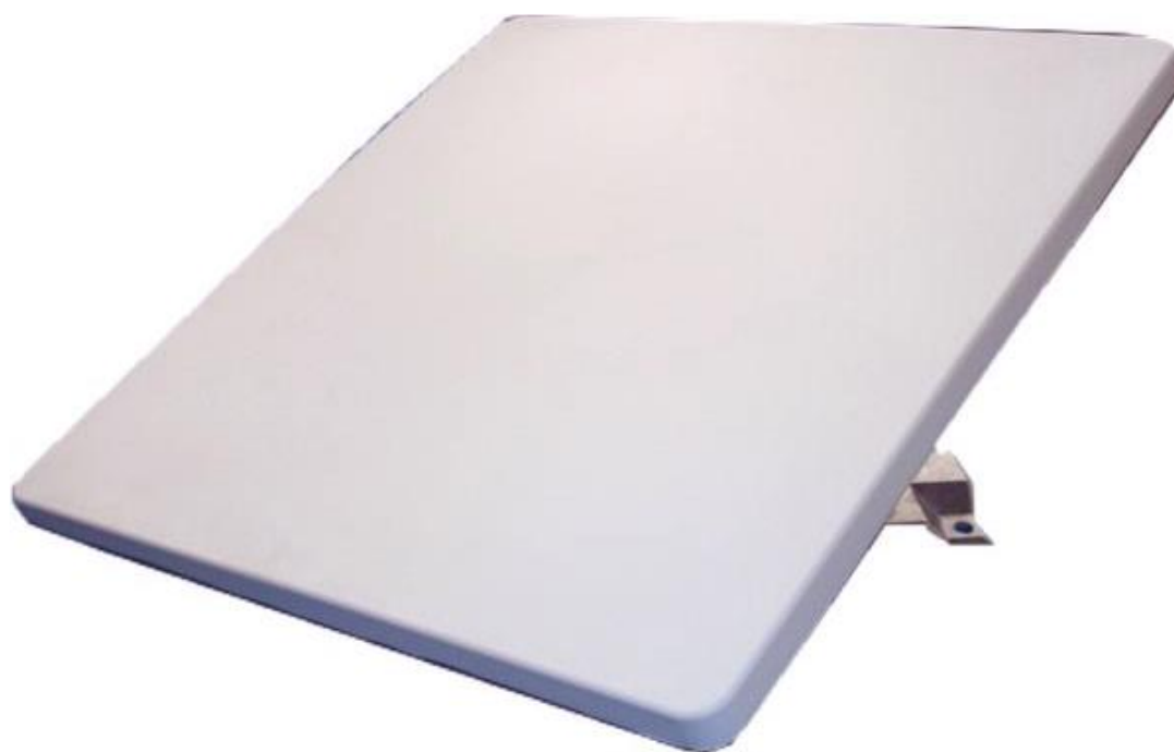
Rys. 2.2.11. Przykład konstrukcji anteny planarnej PA-5000-23 o zysku 23 dBi na pasmo 5,1 – 5,825 GHz (dla standardów 802.11a/n). Antena ma polaryzację liniową, szerokość wiązki w obu płaszczyznach 16°, wymiary 322 x 322 x 12 mm i waży ok. 1360 g. Dopuszczalna moc doprowadzona do jej zacisków (gniazda N) wynosi 10 W. Zysk przystępnych anten planarnych na pasmo 2,4 GHz jest przeważnie trochę niższy i wynosi ok. 20 dBi. Anteny planarne stanowią praktyczną alternatywę dla rozpowszechnionych anten parabolicznych
